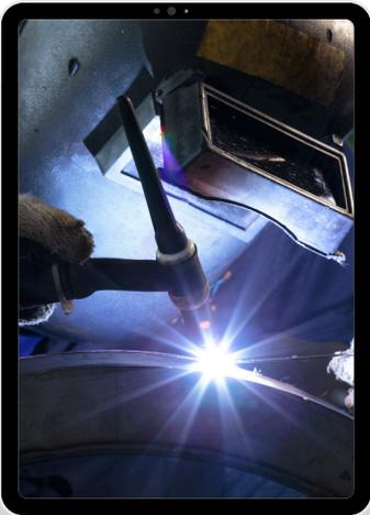
Fabricados em aço GG 40 de alta condutibilidade, mola de aço, fixação do cabo de solda por parafuso tipo bujão, isolamento em polímero ou baquelite, punho em fenolite. Boa condutibilidade elétrica e resistência, indicado para serviços de caldeiraria, montagem industrial e solda de tubos. Ótima isolamento térmica e elétrica com componentes anti-chama para boa resistência e segurança do operado.
